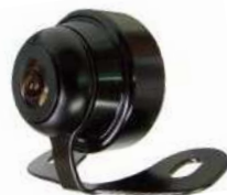
AVZ1PM: caméra CMOS 155°, 0,6 lux, IP68, 8 mètres de câble, NTSC
