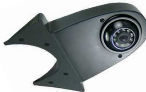
CAM10CY: caméra CCD 110° avec vision nocturne, 0 lux, IP68, 20 m. de câble, PAL, taille de la caméra: 200mmX129mm.
