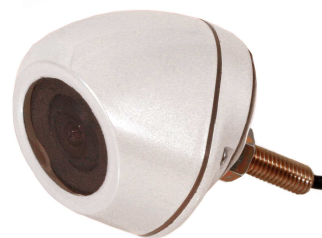
AVCAM9/10: caméra CCD 160°, 1,5 lux, IP67, 10 mètres de câble, PAL
